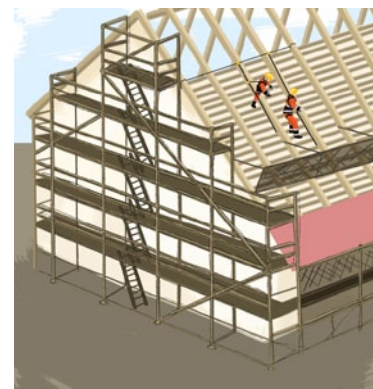
Рис. 6. Вспомогательные строительные леса
